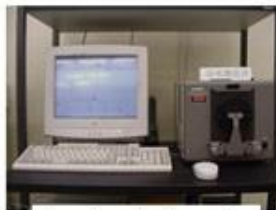
Spectrophotometer Minolta CM-3700d 360-740nmeter
